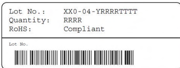
図 19: リール上の最初のラベル: XX = センサタイプ (11 ならば SHT11)、04 = チップのバージョン番号 (V4)、Y = 製造年の最終桁、RRRR = リール内のセンサ数、TTTT = トレーサビリティコード。
